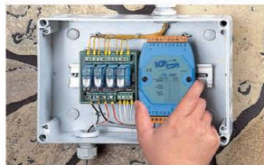
Montage mit externen Solid State Relaismodulen
