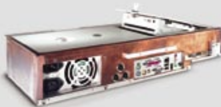
IPC-Komplettsystem für OP-Säle mit frontseitiger Schutzart IP 65
